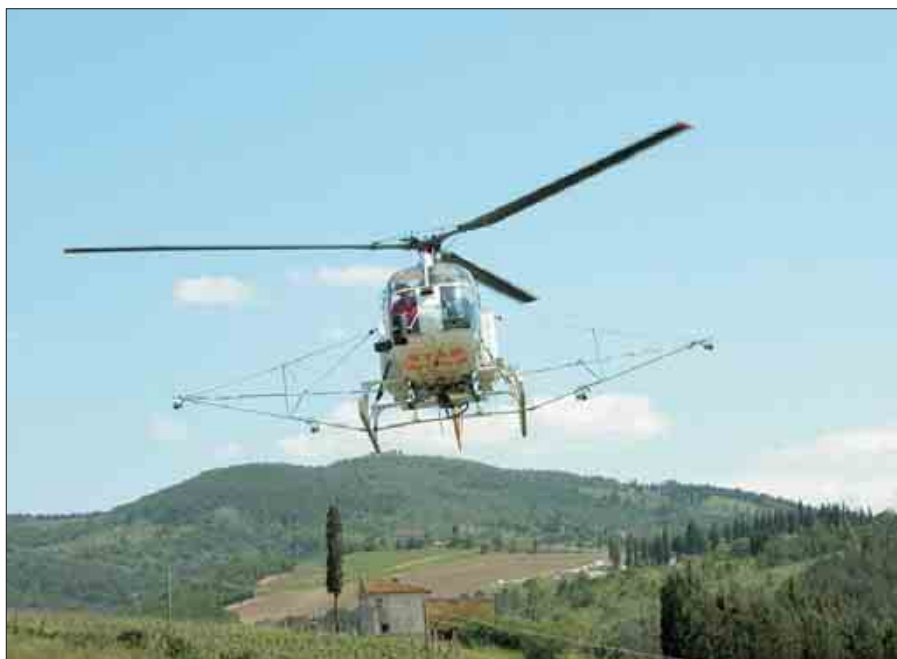
Fig. 7 Elicottero «Aérospatiale SA 315» Lama usato per il trattamento
