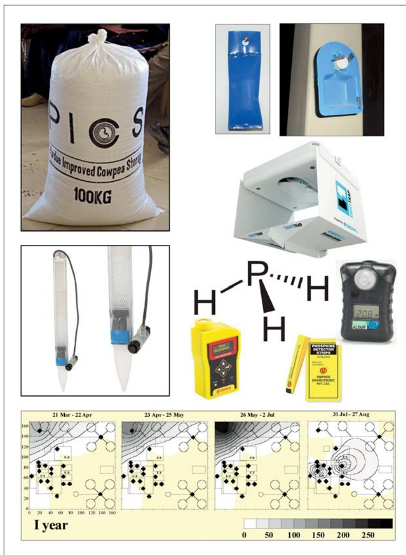
Fig. 1 – Sacco PICS; dispenser feromonico per confusione sessuale e per auto-confusione sessuale di lepidotteri; trappole elettroniche per il monitoraggio di lepidotteri e di coleotteri; attrezzatura per il controllo di gas tossico a rilascio controllato; esempio di mappe di distribuzione spazio temporale di insetti in una riseria.
