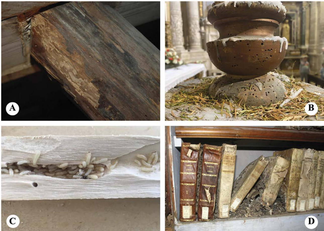
Fig. 1 - Danni da insetti su materiale ligneo: coleotteri cerambicidi su trave (A); coleotteri anobini su candelabro (B); parte di una colonia di Cryptotermes brevis all'interno di un cassettone; Reticulitermes lucifugus su volumi in archivio (A-B foto Ezio Peri; C Sara Basile; D Gaetano Matranga).
